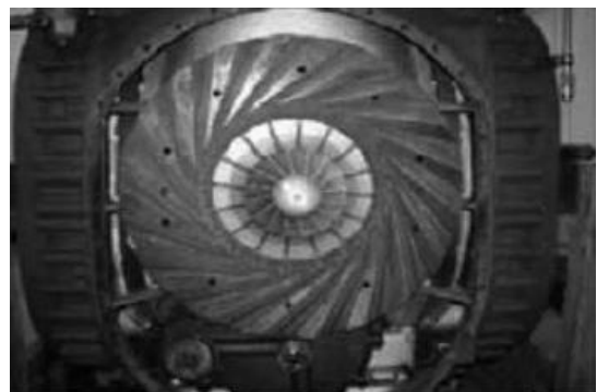
Figura 13 – Teledyne RGT - 3600 microturbina - Detalhe do compressor centrífugo e difusor (7)
